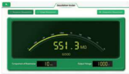
Detección de aislamiento
